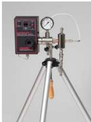
Figura 2.7 – Analisador de umidade (método de espelho resfriado)
