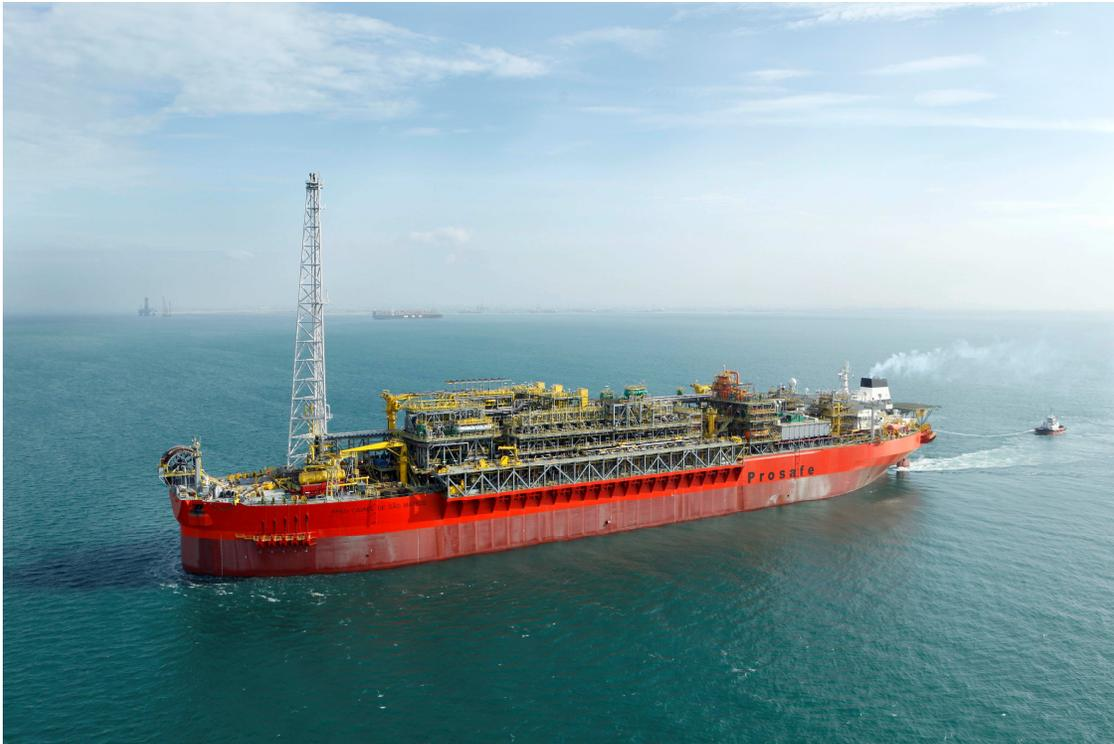
Figura 1.2 - Plataforma de produção de óleo e gás do tipo FPSO
