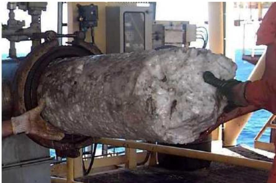
Figura 1.6 - Bloqueio por hidrato em linha de exportação de gás
