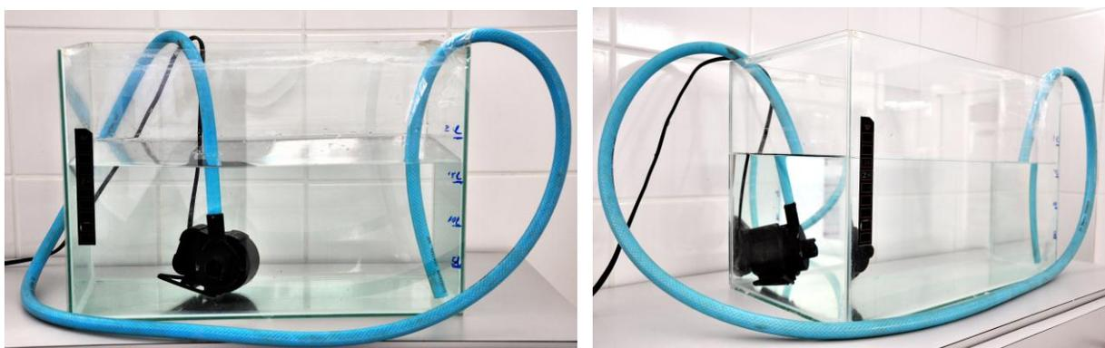
Figura 7: Dispositivo para formação de biofilmes em lâminas.
