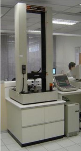
Figura 16. Equipamento Instron modelo 3367 e célula de carga de 1kN.
