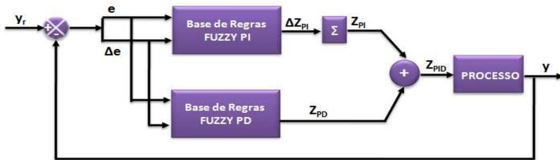
FIGURA 5.20. Estrutura híbrida do controlador *Fuzzy-PID*.
