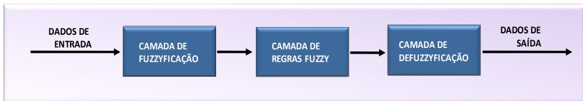
FIGURA 5.32. Diagrama esquemático de um sistema *neuro-fuzzy*.
