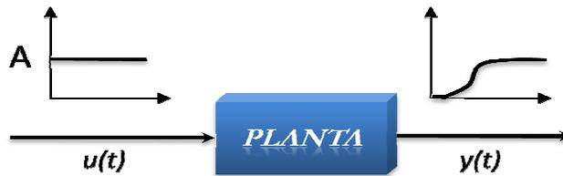
FIGURA 4.12a. Resposta de um processo a uma perturbação do tipo degrau (Ziegler-Nichols).
