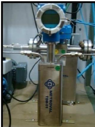
FIGURA 2.17. Transmissor de densidade para medidas on-line utilizado no sistema de polimerização.
