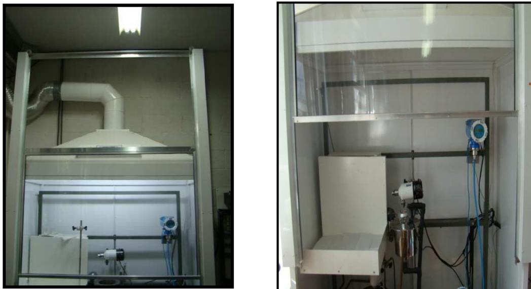
FIGURA 2.3. Capela modular para o sistema de polimerização.
