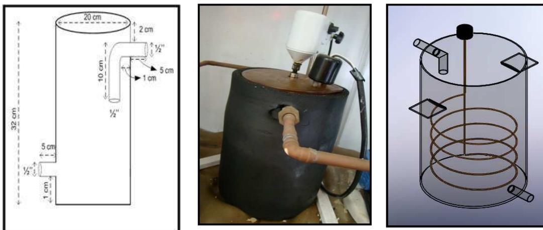
FIGURA 2.5. Projeto de confecção do tanque de armazenamento de fluido térmico.
