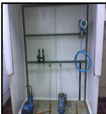
FIGURA 2.2. Suporte metálico para o sistema de polimerização.
