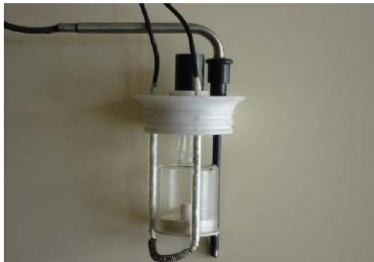
**Figura 5.3.2 – Tampa de Teflon do Vaso Dewar** – Nesta tampa se encontram inseridos a célula de vidro, o termistor e a resistência elétrica.
