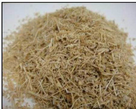
**Figura 3.** Partículas de bagaço de cana-de-açúcar *in natura* com dimensão na faixa entre 0,5 e 1 mm.
