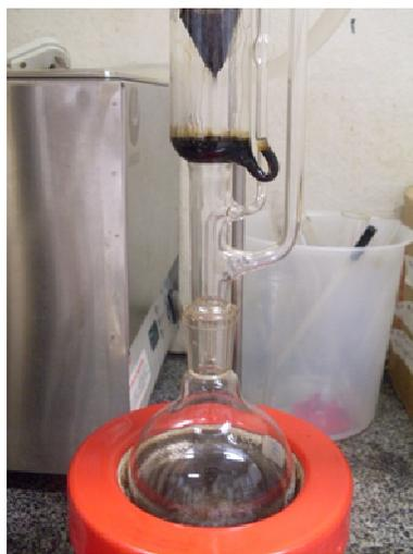
**Figura 3.3** Extração *Soxhlet* dos asfaltos utilizando tolueno como solvente. Depois de 2h o solvente foi ficando incolor
