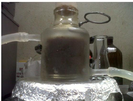
**Figura 3.5** Reator (Célula de vidro) utilizado nos ensaios de desaromatização a furfural e desparafinação a metil isobutil cetona. Etapa de cristalização de parafinas, resfriamento a -7°C
