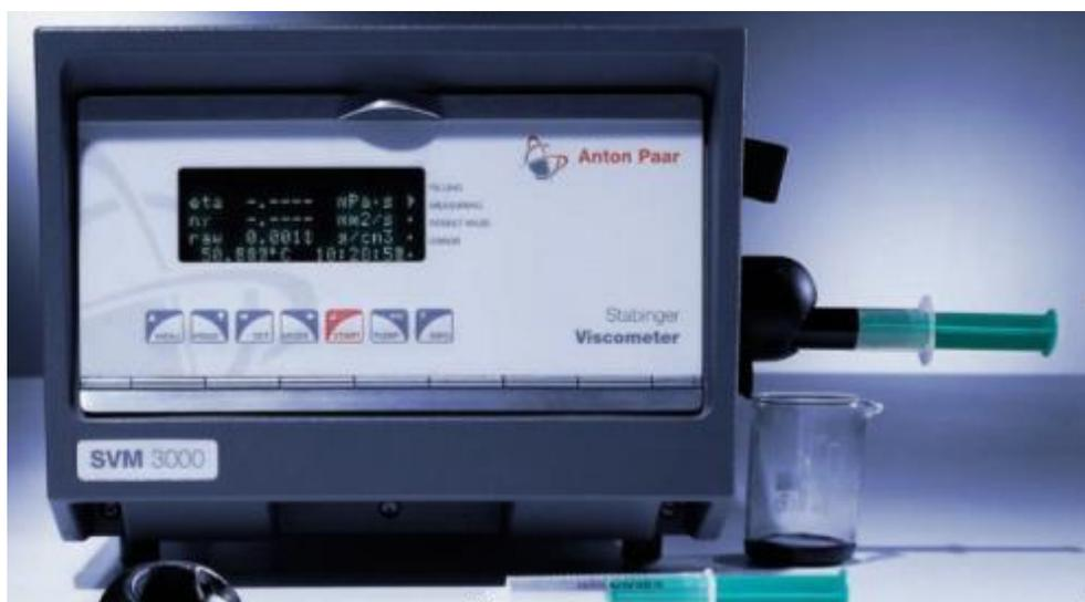
**Figura 3.10** Viscosímetro Stabinger SVM 3000.
