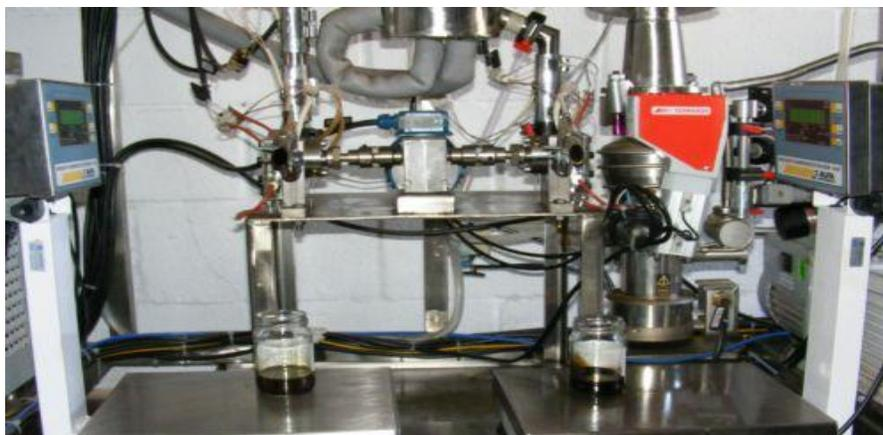
**Figura 3.6** Sistema de coleta de resíduo e destilado.
