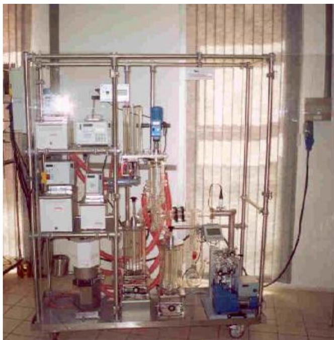
**Figura 3.1** Foto do destilador molecular de filme descendente importado pertencente ao LDPS/FEQ/UNICAMP.
