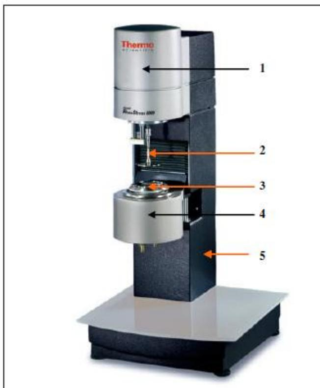
**Figura 3.12** Reômetro HAAKE RheoStress 6000, para medições das viscosidades dos resíduos da destilação molecular. (THERMO SCIENTIFIC, 2007).
