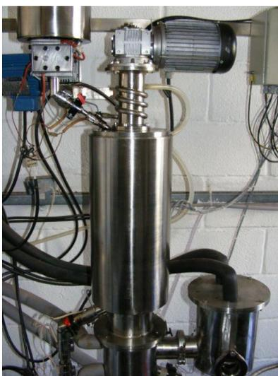
**Figura 3.5** Sistema de evaporação.
