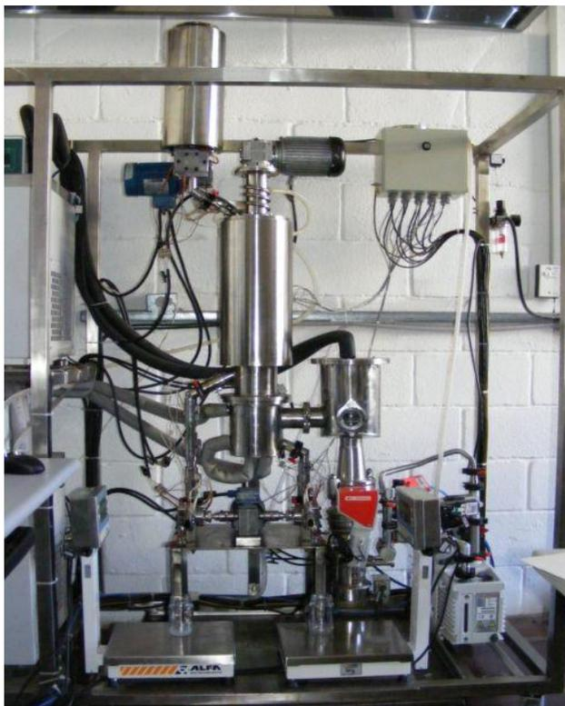
**Figura 3.2** Foto do protótipo nacional de destilador molecular de filme descendente pertencente ao LOPCA/LDPS/FEQ/UNICAMP.
