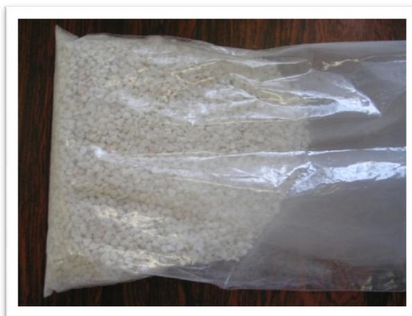
FIGURA 3.8 – Suporte ( $\alpha$ -alumina) com diâmetro aproximado de 2mm.
