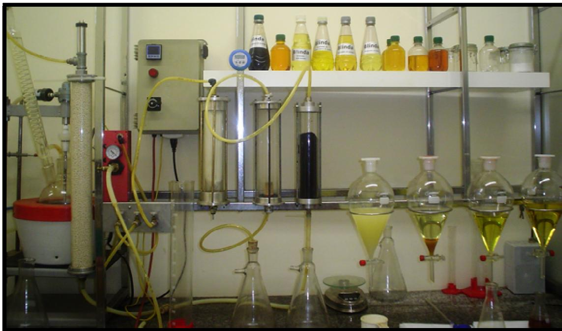
FIGURA 3.2 – Sistema de produção de Biodiesel
