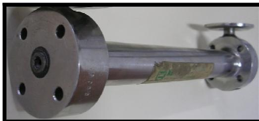
FIGURA 3.5 – Módulo de membrana inox utilizado no trabalho.
