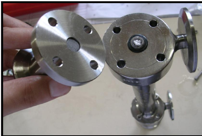
FIGURA 3.6 – Fixação do leito dentro da membrana.
