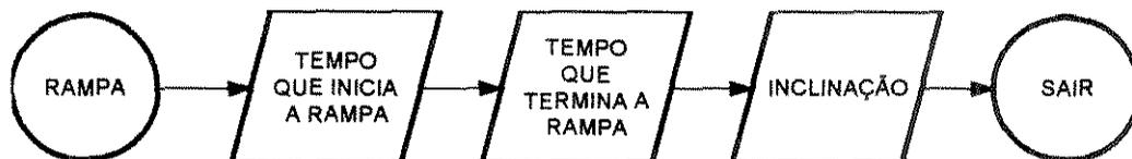
*Figura E.23 Fluxograma da subrotina RAMPA*
