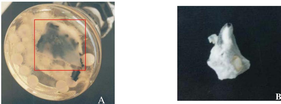
**Figura V.22: (A) Teste de biodegradação em meio líquido realizado para a blenda 60% LIG/PHBV, processada em Haake, utilizando o *Trametes versicolor*; (B) Amostra liofilizada da blenda 20% LIG/PHBV, processada em Haake, após o teste de biodegradação.**
