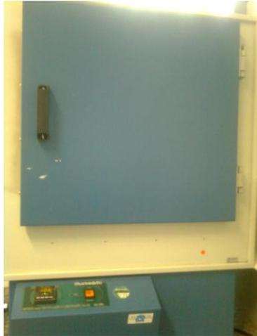
**Figura 3.3** – Estufa de secagem especial Marconi, modelo MA-035/2
