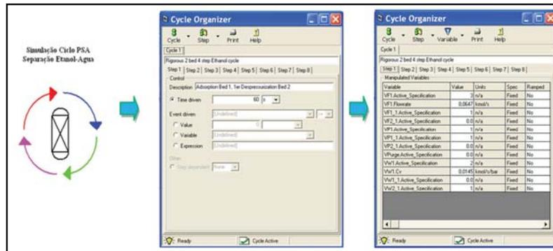
Figura 4.9: Esquema da ferramenta *Cycle Organizer* do simulador Aspen Adsim.
