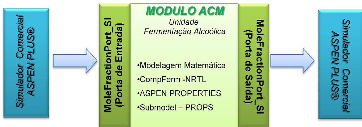
Figura 6.5. Esquema de transferência de dados entre a unidade ACM e o simulador comercial ASPEN PLUS®
