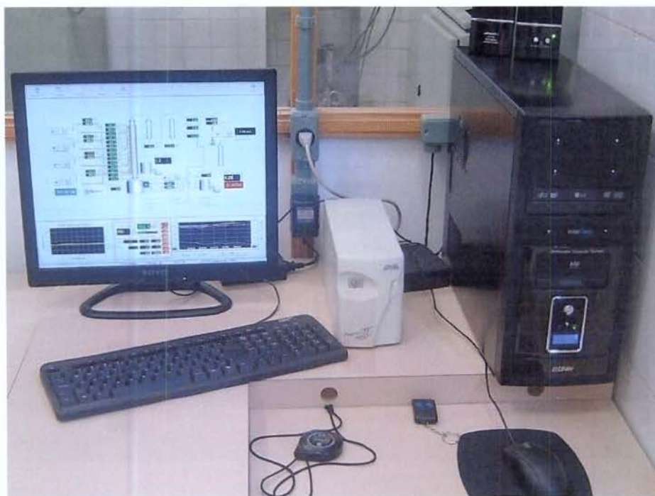
Figura 3.16. Micro computador usado no controle do reator pirolítico.
