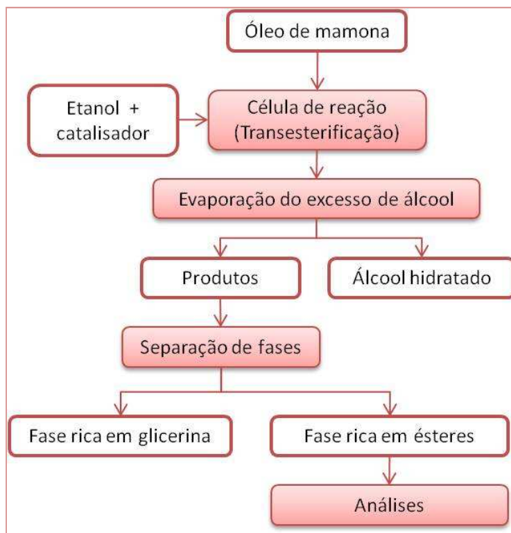
Figura 13. Fluxograma do procedimento da reação de transesterificação usando catalisador homogêneo (NaOH).
