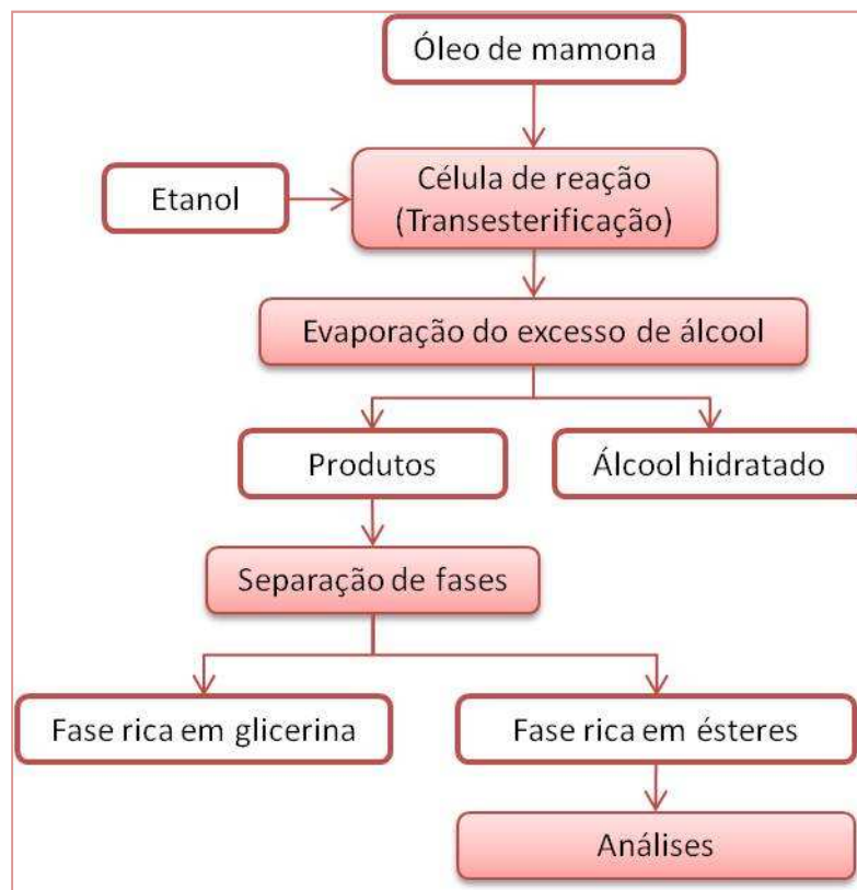
Figura 12. Fluxograma do procedimento de produção da reação de transesterificação sem catalisador.
