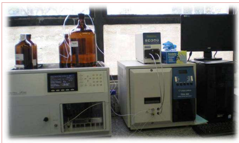
Figura 10. Cromatógrafo VISCOTEK GPC / SEC TDA Max TM , equipamento do Laboratório de Desenvolvimento de Processos de Separação (LDPS/FEQ/UNICAMP).
