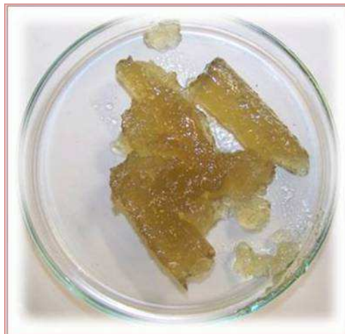
Figura 14. Formação de gel na transesterificação feita com 1 % de catalisador (NaOH). Razão molar etanol:óleo de mamona 16:1, temperatura de 200 °C e tempo de reação de 40 minutos.
