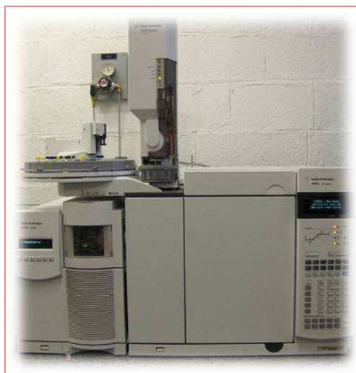
Figura 8. Cromatógrafo Gasoso com FID Agilent Technologies 6850 CG, equipamento do Laboratório de Desenvolvimento de Processos de Separação (LDPS/FEQ/UNICAMP)
