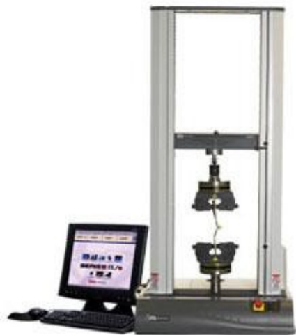
Figura 3.1 – Equipamento Instron de ensaio de tração dos fios de catagute.
