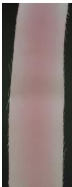
Figura 41: Amostra de tecido de poliéster termofixada a 220 °C por 60s com 10 min de tratamento corona.
