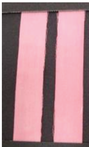
Figura 40: Amostras de tecido sem termofixar. Sem tratamento corona (esquerda) e com 10 min de tratamento corona (direita).
