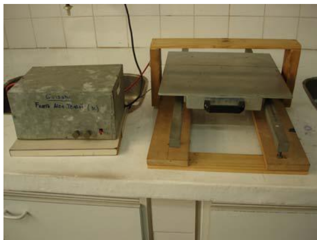
Figura 22: Sistema de descarga corona tipo fio-plano. Laboratório FATEC – Americana.
