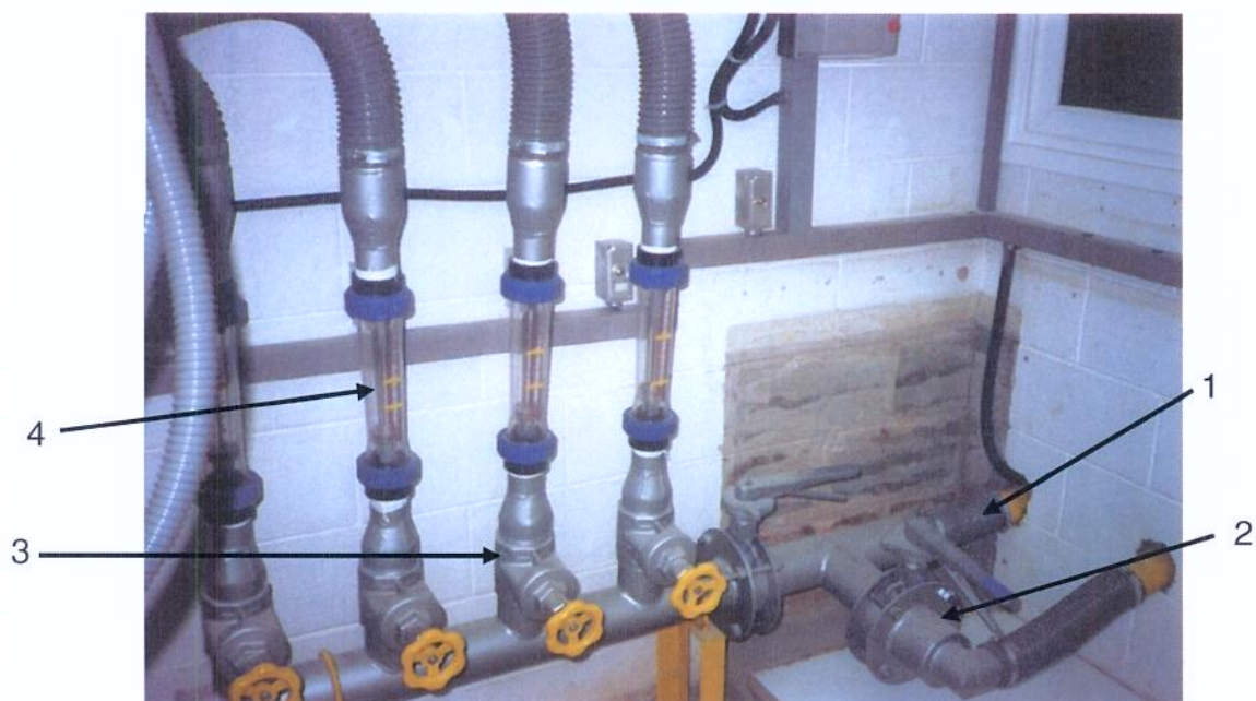
Figura 3.5: Sistema de válvulas (1 – ar principal; 2 – ar de escape, 3 – ar secundários alimentações no downer; curva, entrada e saída do riser; 4 – rotômetros).
