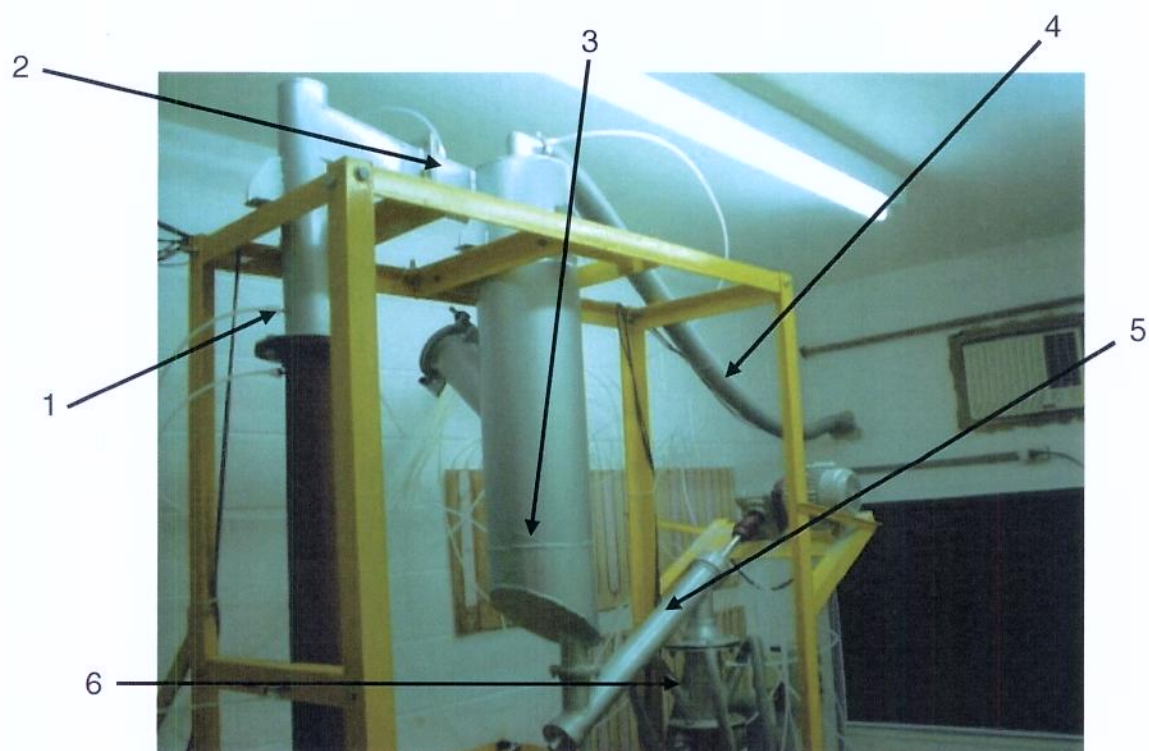
Figura 3.12: Topo de recirculação: (1 – saída do riser; 2 – entrada em venturi na entrada do ciclone primário; 3 – silo de carregamento; 4 – saída do ciclone primário; 5 – alimentador de sólidos; 6 – alimentação do ar na entrada do downer).
