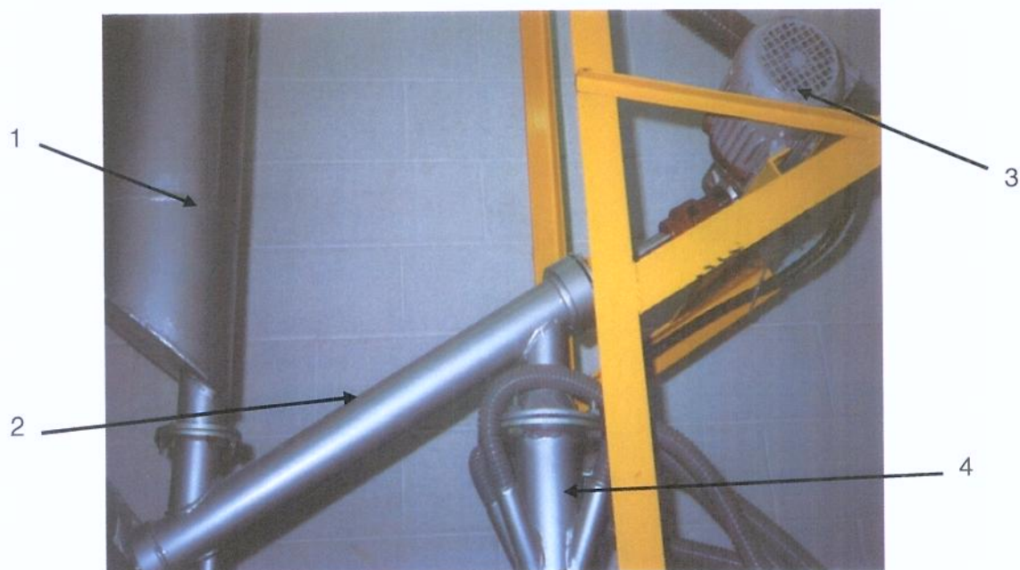
Figura 3.6: Alimentações de sólidos e de ar no downer (1 – reservatório de sólidos; 2 – alimentador de sólidos; 3 – motor do alimentador de sólidos; 4 – alimentador do ar ao downer).
