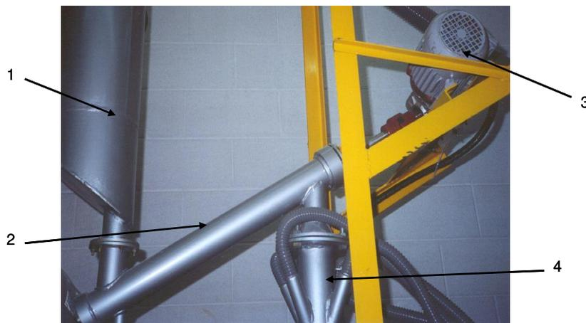
**Figura 3.3.** Alimentações de sólidos e de ar no downer (1 – reservatório de sólidos; 2 – alimentador de sólidos; 3 – motor do alimentador de sólidos; alimentação do downer; 4 – alimentador do ar ao downer).
