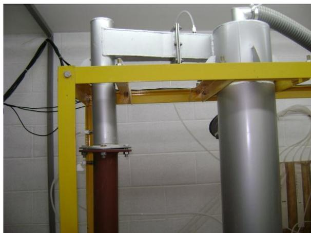
**Figura 3.6.** *Saída abrupta da seção riser da Unidade Multipropósito.*
