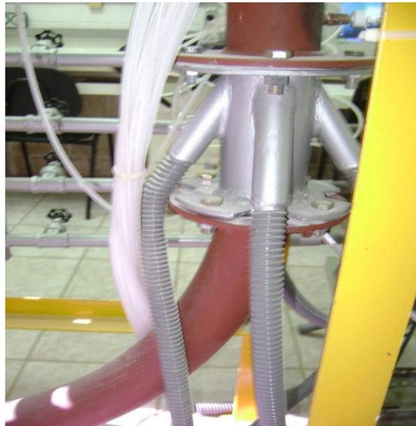
**Figura 3.5.** *Curva em "U", que une o downer e o riser da Unidade Multipropósito.*
