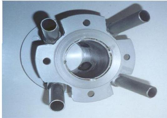
**Figura 3.4.** *Detalhe do alimentador de ar (dispositivo de 4 bicos).*
