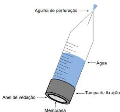
**Figura 3.2** - Dispositivo empregado para a avaliação da capacidade de drenagem de água das membranas (fonte: Rodrigues, 2008).
