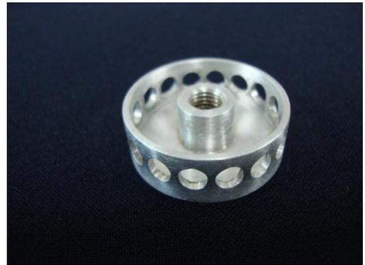
Figura 3.3 – Atomizador tipo B.
