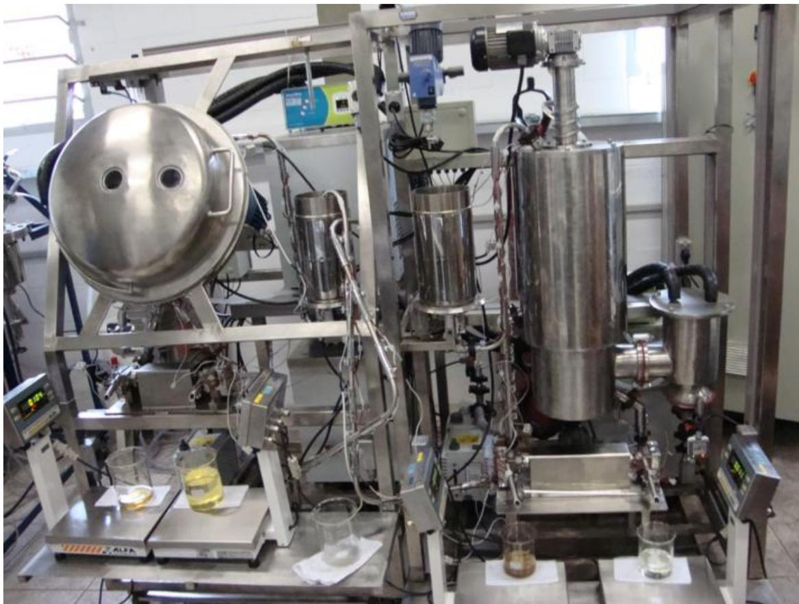
**Figura 4.13:** Destilador Molecular Reativo Centrífugo pertencente ao LOPCA/LDPS em março de 2010, já operacional.
