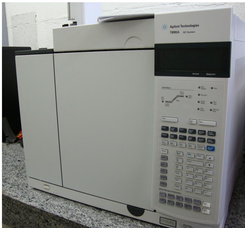
**Figura 3.11:** Cromatógrafo CG/SimDis, Agilent 7890A, pertencente ao LOPCA/LDPS.
