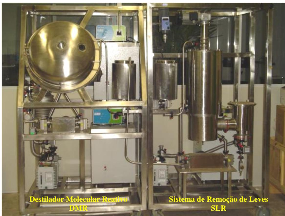
**Figura 4.1:** Destilador Molecular Reativo construído pertencente ao LOPCA/LDPS (Foto tirada em março de 2009).
