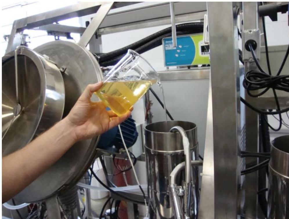
**Figura 5.1:** Alimentação do destilador molecular reativo com óleo lubrificante B.
