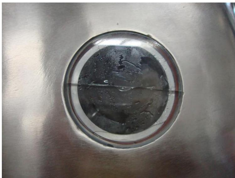
**Figura 5.5:** Trinca no vidro do DMR.
