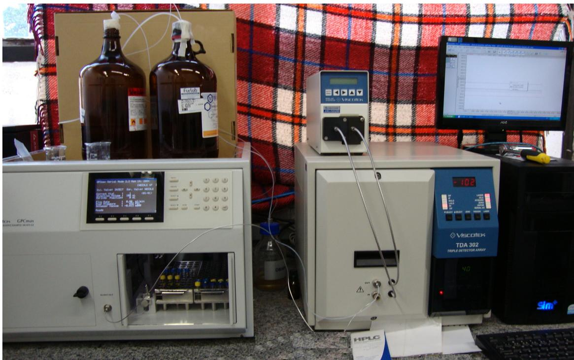
**Figura 3.10:** GPC MAX modelo TDA 320 pertencente ao LOPCA/LDPS.
