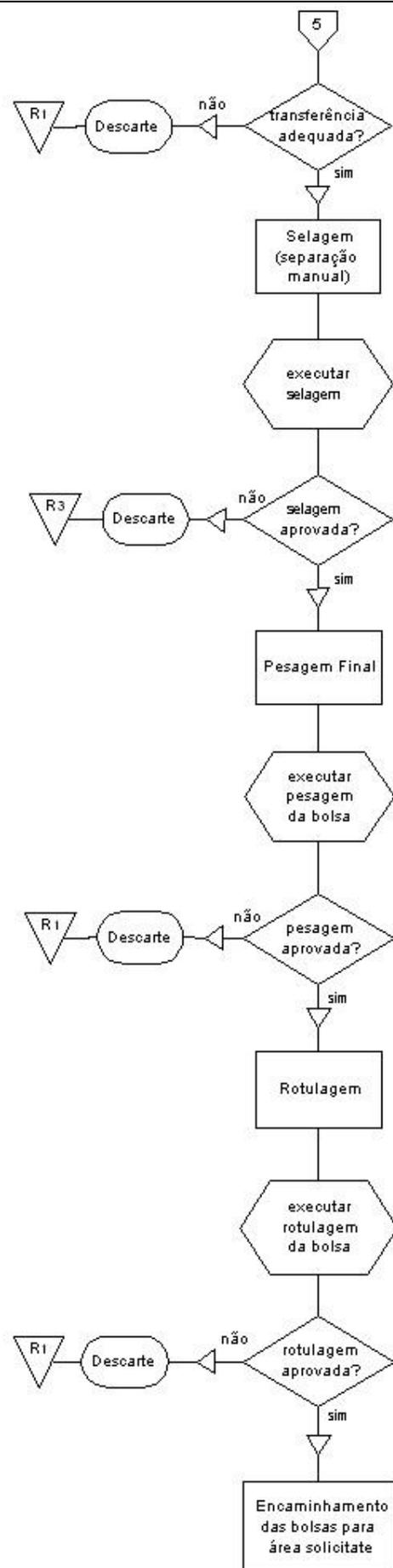
Conforme exemplo na Figura 3.3, os módulos são utilizados na metodologia do HAZOP, pois geralmente estes processos são bem extensos, dificultando sua análise. Desta forma é necessário detalhar e dividir as atividades do processo em sub-atividades ou subsistemas para facilitar a aplicação da técnica.
