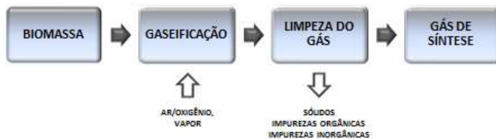
Figura 2.3. Diagrama do processo de gaseificação da biomassa.
