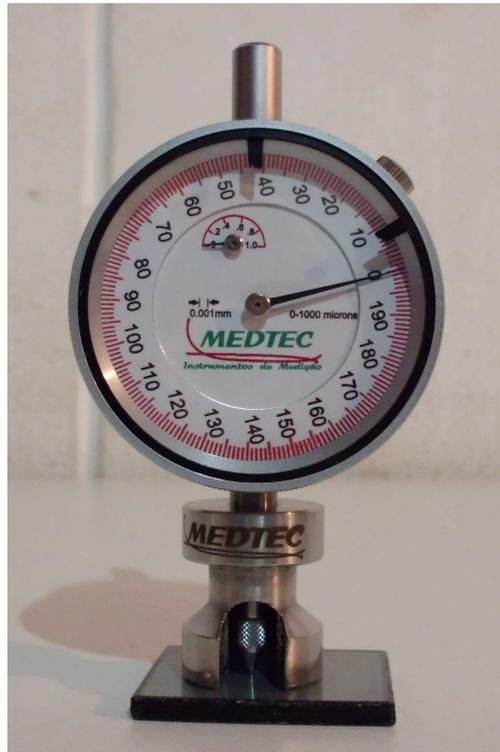
Fig. C.1: Medidor de perfil de superfície marca MEDTEC mod.: MED–321A.
