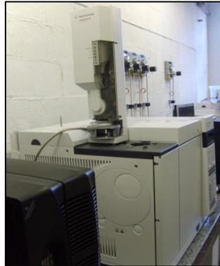
**Figura 3.2** - Cromatógrafo para destilação simulada da Agilent Technologies 7890A.
