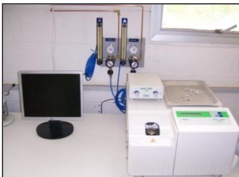
**Figura 3.21** - Calorímetro diferencial de varredura (DSC) *Mettler Toledo*, modelo *DSC-823e*.
