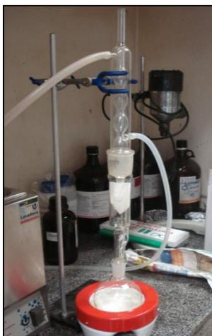
**Figura 3.5** – Sistema de extração soxhlet.
