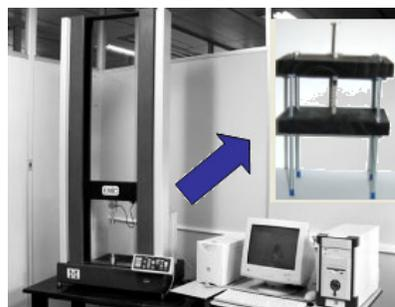
**Figura 3.2.** Suporte para acoplamento das seringas usadas nas análises de força de extrusão.
