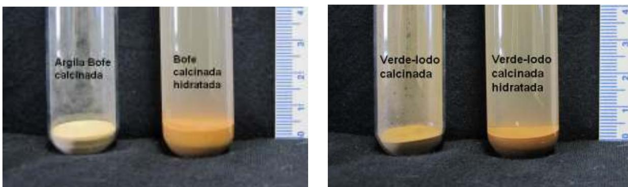
Figura 4.9 – Hidratação das argilas Bofe e Verde-lodo calcinadas.
