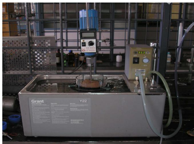
**Figura 4.3:** Sistema usado nos experimentos de cinética de adsorção.
