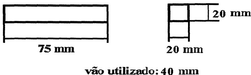
**Figura 5.17: Ilustração do corpo-de-prova utilizado no ensaio de resistência ao impacto Charpy. Dimensões em milímetros (ASTM D 256 – 1987).**
