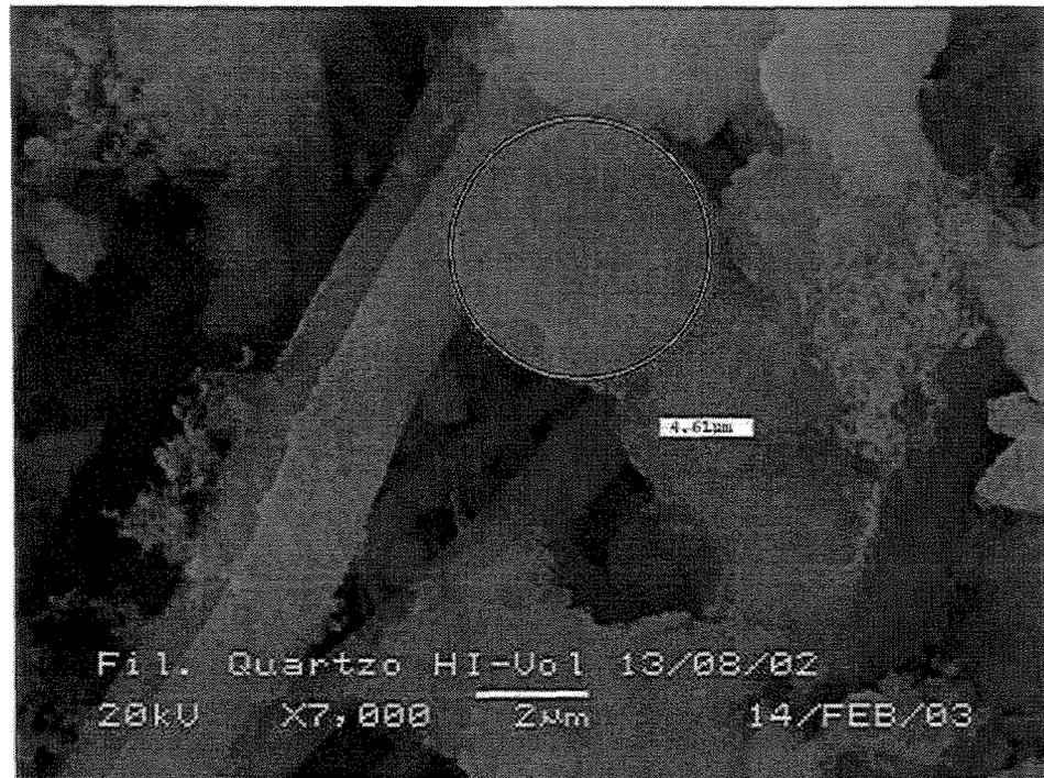
Figura A.3: Micrografia do filtro de microfibras de quartzo amostrada em 13/08/2002 com aumento de x7000.
