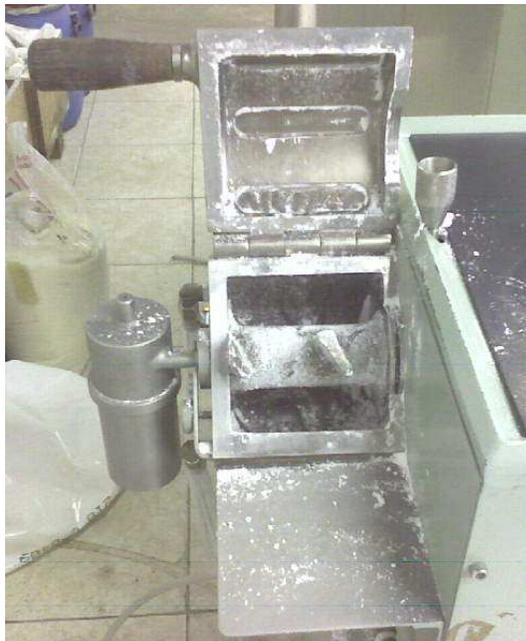
Figura 29: Câmara do misturador de alto cisalhamento, MH 50, da MH Equipamentos.
