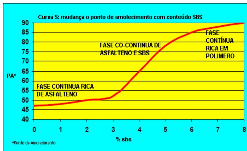
Figura 34: Curva S indicando PA versus elasticidade
