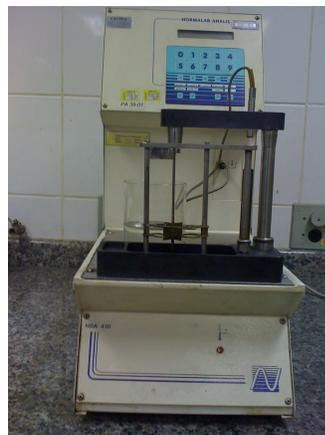
Figura 47: Aparelho de Ponto de Amolecimento
