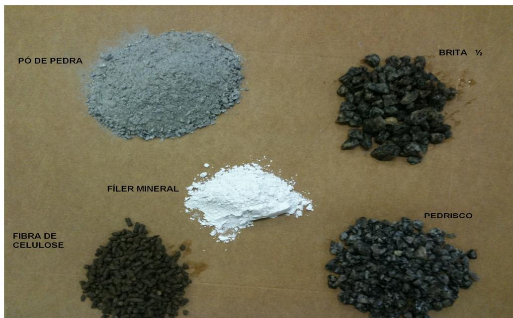
Figura 85: Componentes da mistura de SMA.
