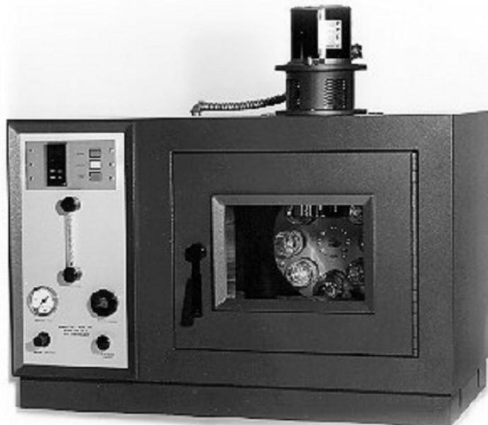
Figura 52: Forno CS325-B de RTFOT.
