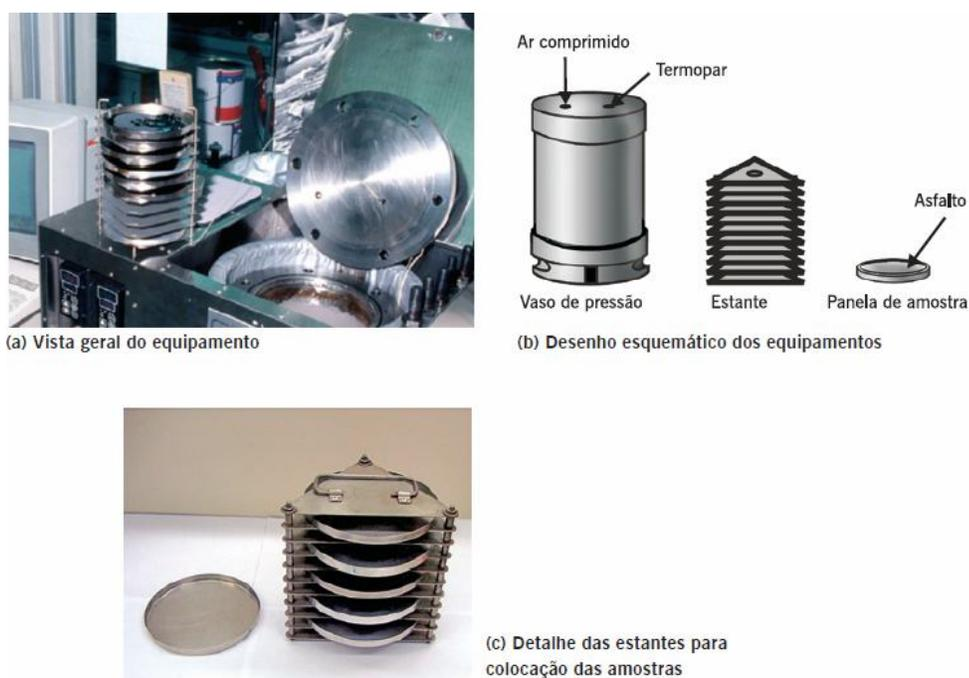
Figura 65: Equipamento para PAV
