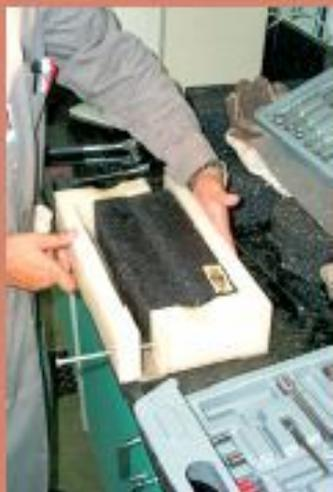
(e) Placa deformada sendo desmoldada
