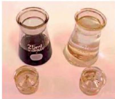
(a) Picnômetros com asfalto e água
