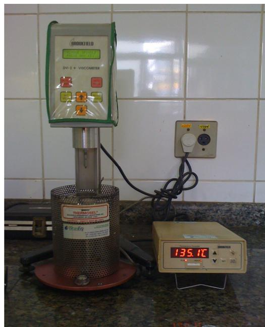
Figura 51: Esquema de aparelhagem (a) e (b); Viscosímetro Brookfield (a).
