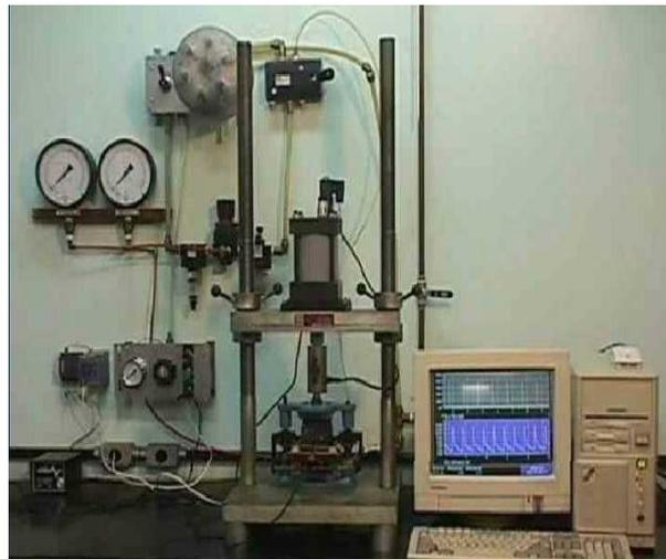
Figura 68: Determinação do módulo de resiliência
