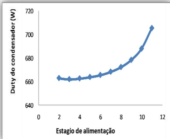
Figura 58. E. do condensador Vs P. de alimentação
