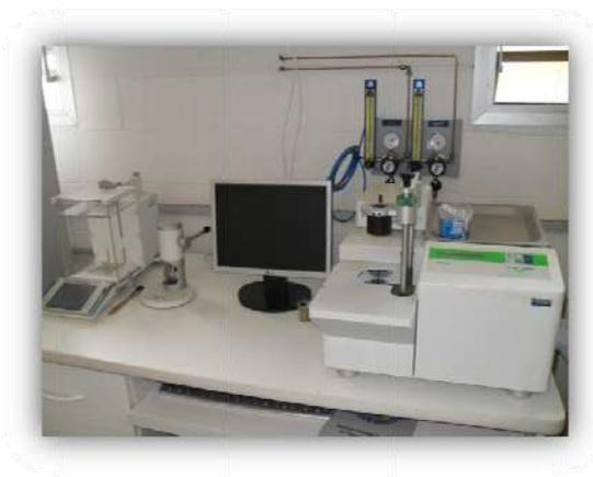
**Figura 11. Calorímetro diferencial de varredura (DSC) instalado no LOPCA/FEQ/UNICAMP**
