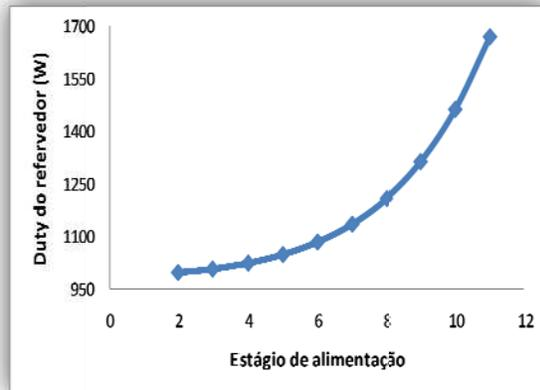
**Figura 83. Energia do refeedor Vs posição de alimentação (soja)**
