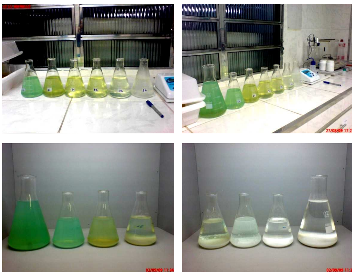
Figura 52: Tratamento de Efluente com Eletrodos de Alumínio onde vemos o efluente bruto mostrado do lado esquerdo e depois as amostras coletadas de hora em hora.
