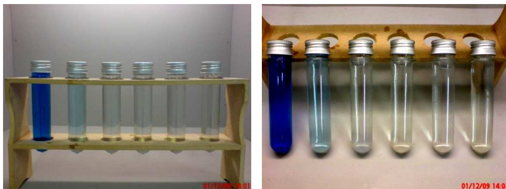
Figura 74: Tratamento de Efluente Simulado com Eletrodos de Alumínio. Na figura vemos o efluente bruto mostrado do lado esquerdo e depois as amostras coletadas de 10 em 10 minutos.
