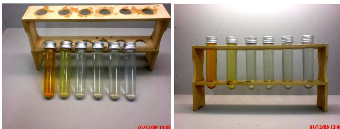
Figura 68: Tratamento de Efluente Simulado (amarelo) com Eletrodos de Alumínio Na figura vemos o efluente bruto mostrado do lado esquerdo e depois as amostras coletadas de 10 em 10 minutos.
