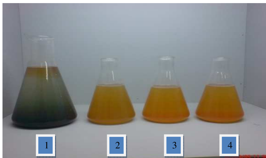
Figura 42: Tratamento de Efluente com Eletrodos de Ferro, sendo que amostra 1 refere-se ao efluente bruto e depois as amostras 2 a 4 foram as coletadas de hora em hora.
