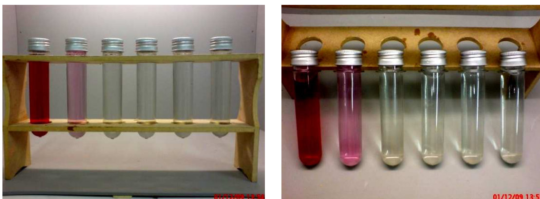
Figura 71: Tratamento de Efluente Simulado (vermelho) com Eletrodos de Alumínio. Na figura vemos o efluente bruto mostrado do lado esquerdo e depois as amostras coletadas de 10 em 10 minutos.
