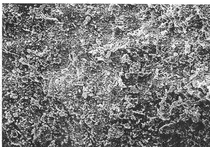
Argila do tipo Bentonita calcinada a 500°C
