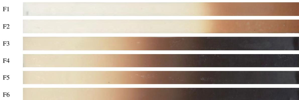
Figura 4.10 – Resultados visuais de estabilidade térmica estática das formulações de PVC/O-MMT: 1 hora a 210°C.
