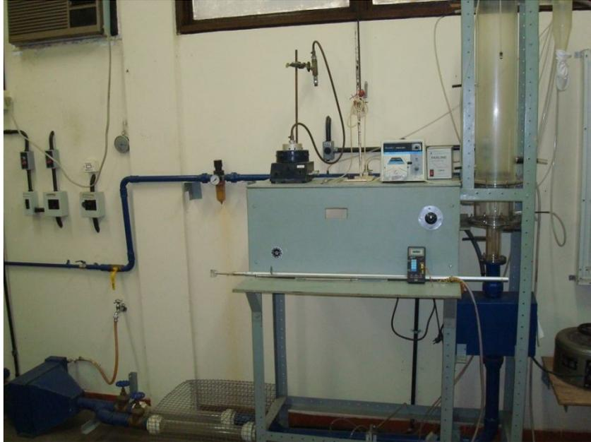
Figura 3.9. Aspecto do leito fluidizado utilizado no recobrimento de sementes de jambu
