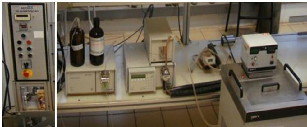
**Figura 3.4 - Módulo de alimentação do solvente e/ou cossolvente.** Fonte: (BUTZKE, 2013d).
