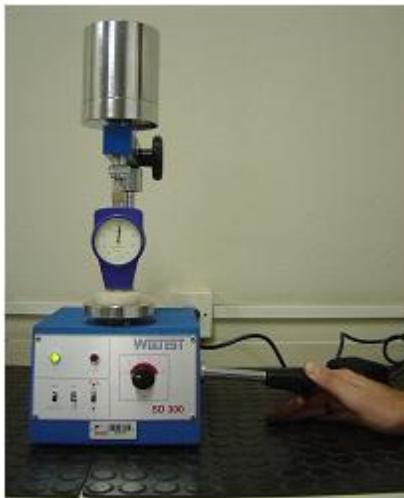
Figura 3.3 –Durômetro Microtest 7206 SB- Dureza Shore D
