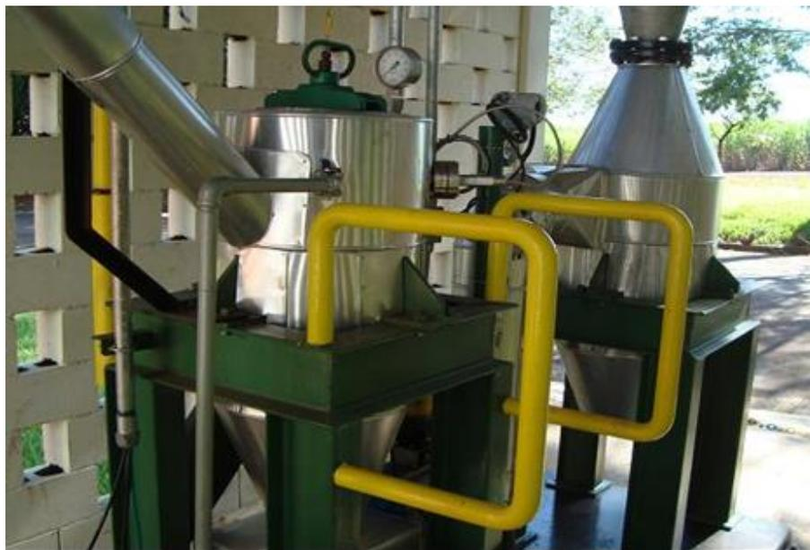
Figura 3.2: Reator de pré-tratamento “Steam Explosion”.
