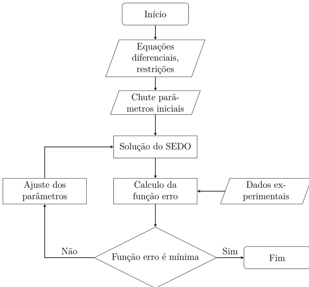
Figura 2.14: Esquema de solução pelo enfoque sequencial aninhado.
