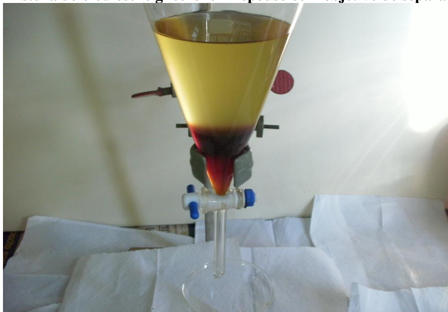
Figura 17 - Mistura de biodiesel e glicerol em repouso com objetivo de separação de fases.
