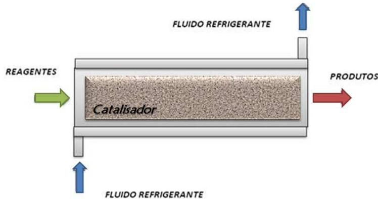
Figura 2.1 Esquema de um Reator Catalítico de Leito Fixo
