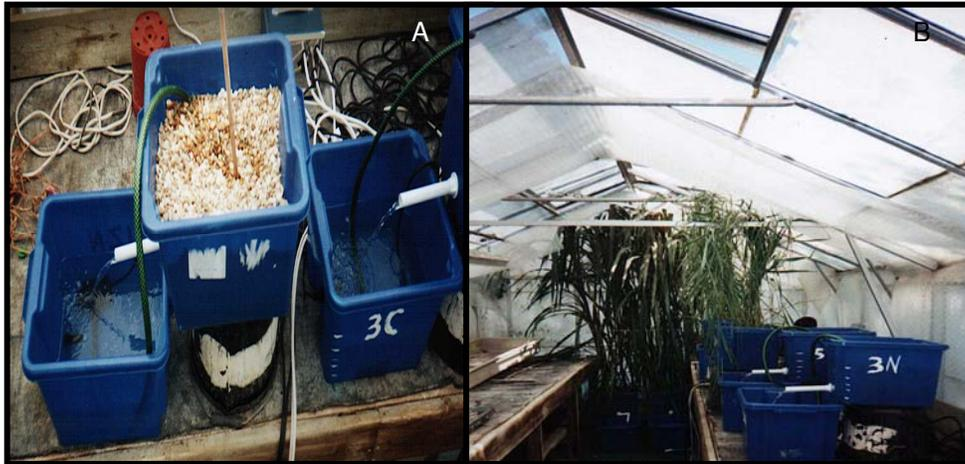
Figura 4.1 – “Reed Bed” piloto (A) e sistemas utilizados (B)
