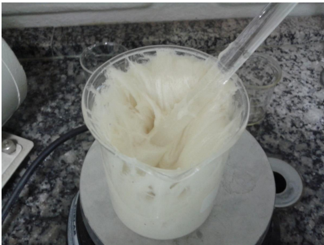
Figura 3.2. Síntese PUB 1.5 - Mistura e aquecimento.
