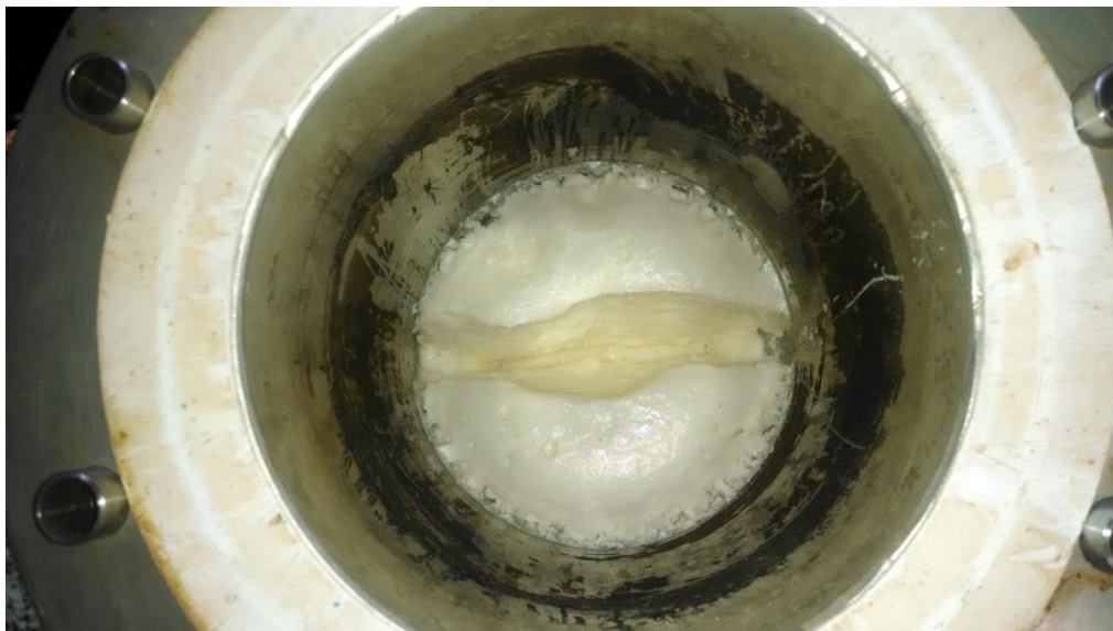
Figura 3.9. Produto final da síntese de PUB 1.5 dentro do reator.
