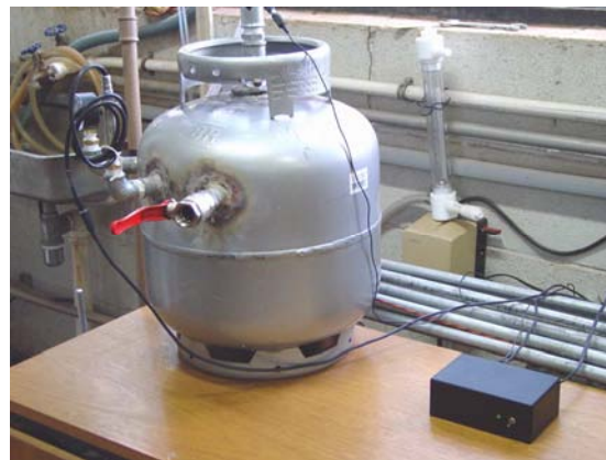
Figura 3.10 – Vaso de pressão e pré-amplificador de microfone
