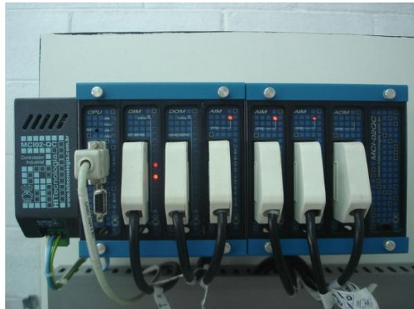
Figura 3. 5 Controlador Lógico Programável (CLP) MCI02-QC (HI Tecnologia) utilizado no projeto.
