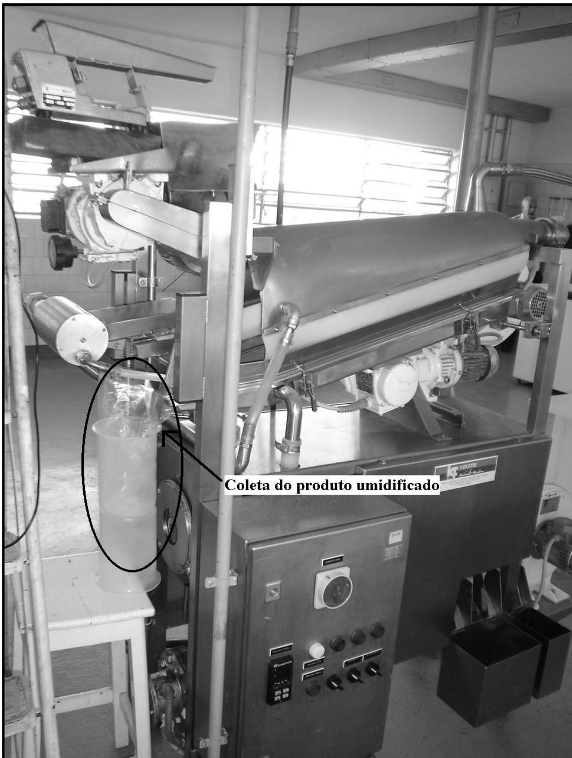
Figura G.3: Fotografia do sistema utilizado para a coleta do produto umidificado dos ensaios para determinação do ganho de umidade dos pós Mor-rex com e sem óleo realizados no mini-instantaneizador do Cereal Chocotec/ITAL.
